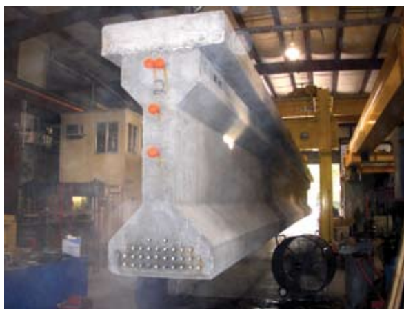
AASHTO Type IV girders
